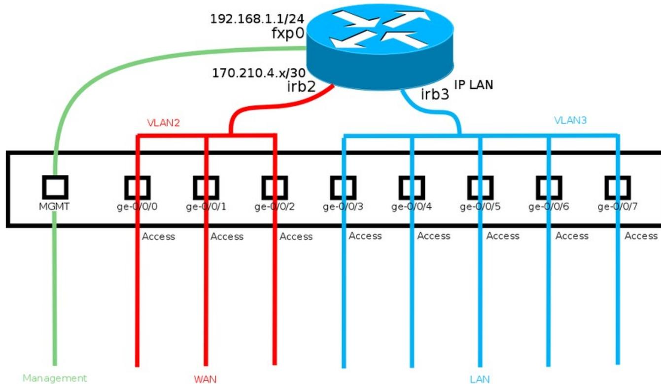
La idea de esta configuración es poder contar con una interfaz de WAN con reserva de otro puerto que permita, de ser necesario, configurar un Link Aggregation y otro puerto extra para conectar por ejemplo un equipo de monitoreo o para pruebas de ancho de banda. Por el lado de la LAN, la disponibilidad de puertos extra permite conectar distintos equipos sin necesidad de contar con un switch.
